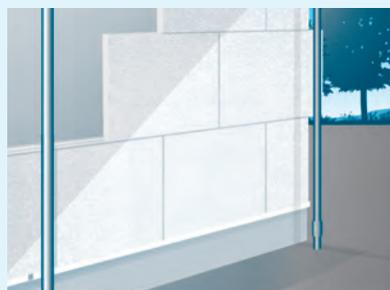
Fig. 4 : Pose des panneaux, façon "joint de pierre"
