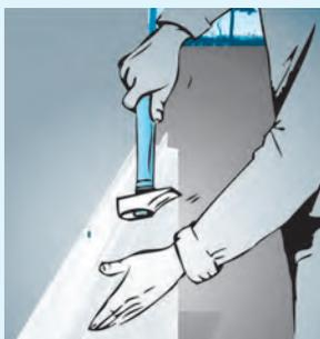
Fig. 9d : Fixation mécanique du profilé
